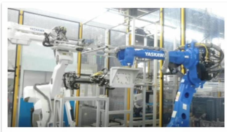
机器人打磨缸体缸盖去毛刺。
